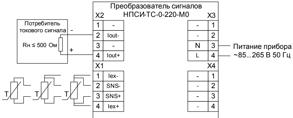
Рисунок 6 – Электрическая схема подключения преобразователей НПСИ-ТС-0-220-МХ, М(Х/М), М(Х/ВС/М)
