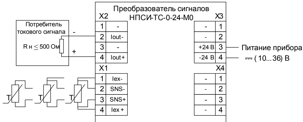
Рисунок 7 – Электрическая схема подключения преобразователей НПСИ-ТС-0-24-МХ, М(Х/М), М(Х/ВС/М)
