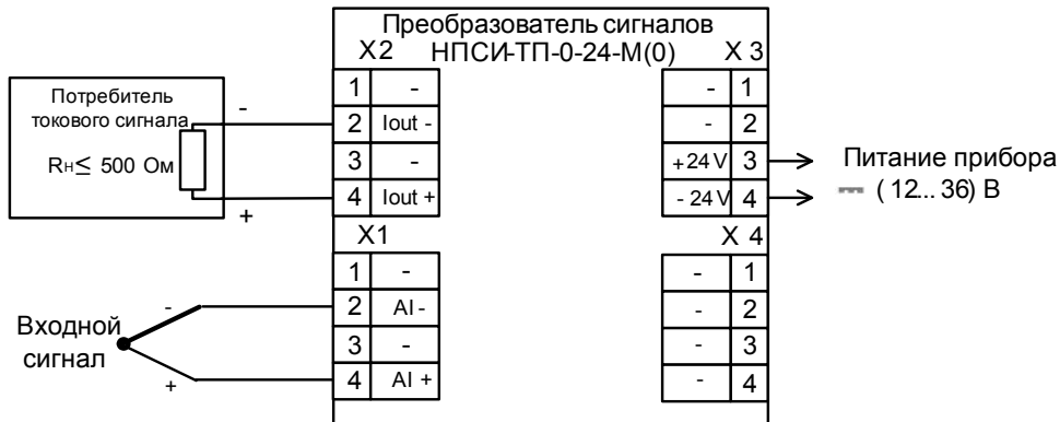
Рисунок 7 – Электрическая схема подключения преобразователей НПСИ-ТП-0-24-М0, М(0/М), М(0/ВС/М)
