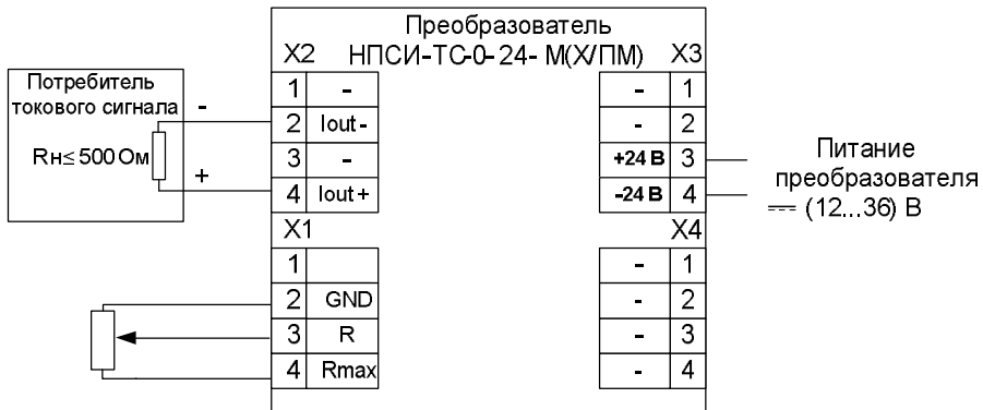
Рисунок 5 – Электрическая схема подключения преобразователя НПСИ-ТС-0-24- М(Х/ПМ)
