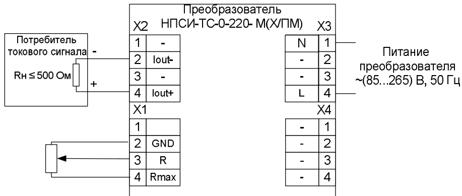
Рисунок 4 – Электрическая схема подключения преобразователя НПСИ-ТС-0-220- М(Х/ПМ)
