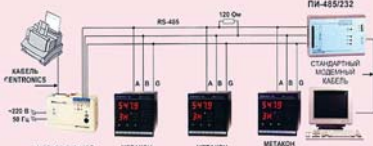
Рис. 2. Структура сети сбора данных и управления
