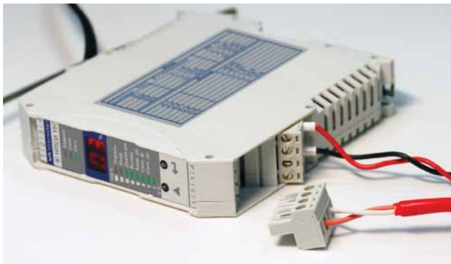
Рис. 5. Подключение внешних линий с помощью разъемных клеммных соединителей
