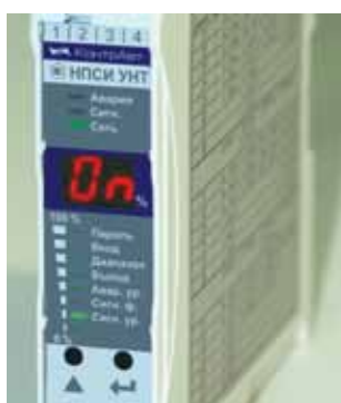
Рис. 7. Органы индикации и управления на передней панели преобразователя
