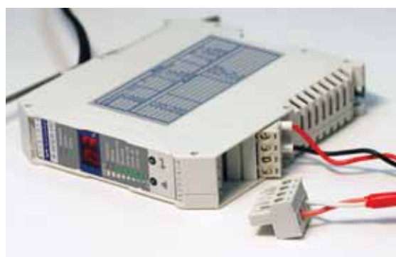
Рис. 8. Подключение внешних линий с помощью разъемных клеммных соединителей
